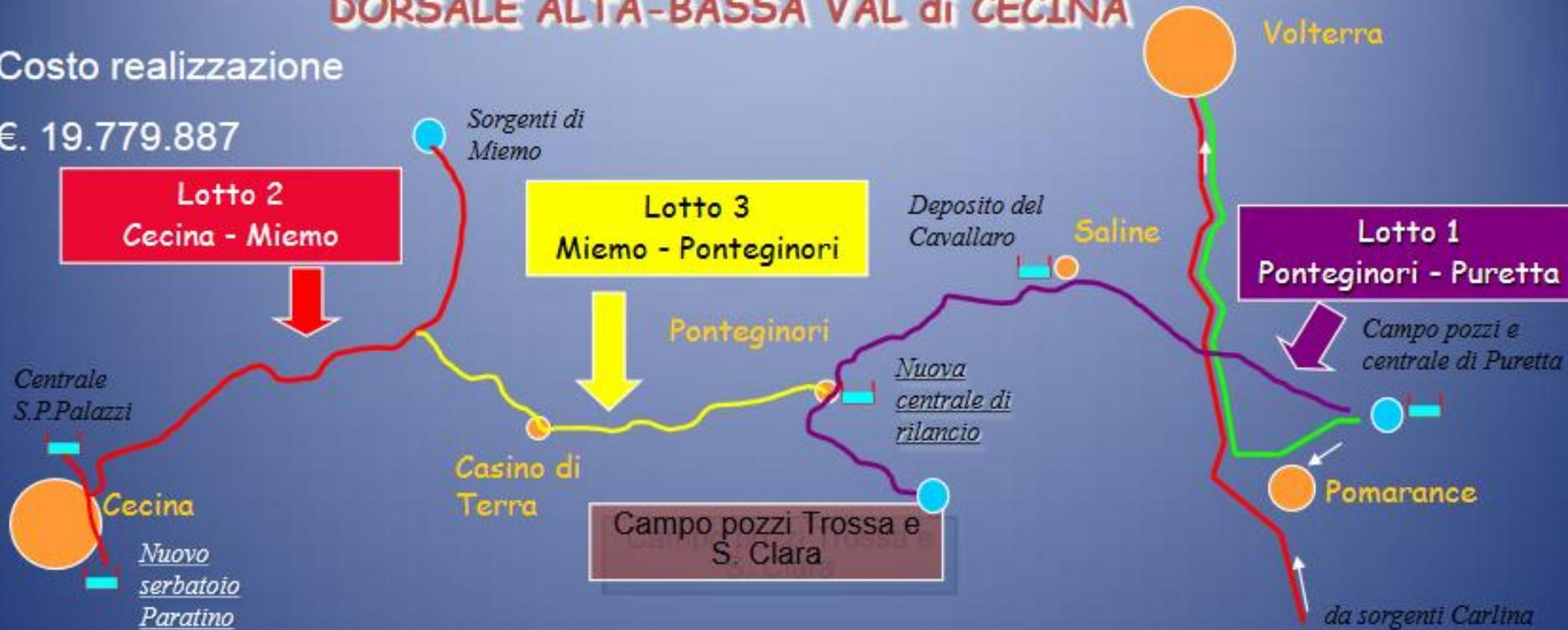
Il progetto prevede l'interconnessione tra il campo pozzi/serbatoio di Puretta e il Comune di Cecina presso il nuovo serbatoio del Paratino.
